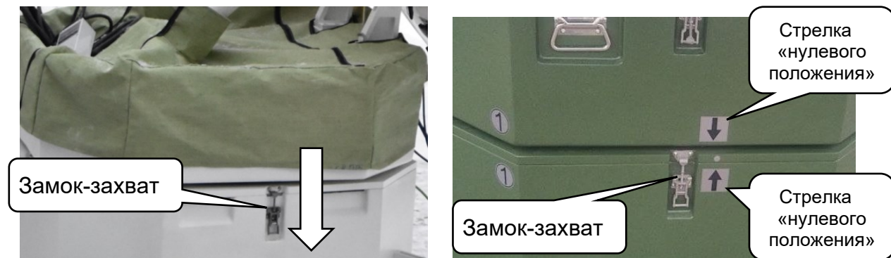
Рисунок 26 – Установка кейсов АП-1,8
